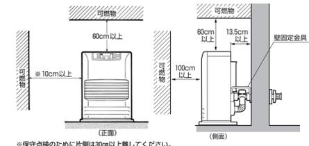
■ 給排気筒トップから周囲の可燃物までの離隔距離は図のようになっています。
