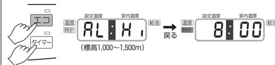
もし、高地設定を解除したいときは、①項の操作からやり直してください。デジタル表示部に「AL Lo」表示が3秒間点滅し、元の表示に戻れば、高地設定の解除は完了です。
