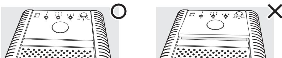
※燃料タンク扉が開いたまま運転すると警報ランプが点灯し運転停止します。
