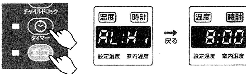
もし、高地設定を解除したいときは、1の操作からやり直してください。ブザー音がしてデジタル表示部に「AL Lo」表示が3秒間点滅し、元の表示に戻れば、高地設定の解除は完了です。
