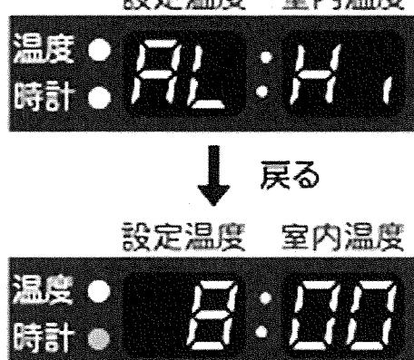
もし、高地設定を解除したいときは、1の操作からやり直してください。ブザー音がしてデジタル表示部に「AL Lo」表示が3秒間点滅し、元の表示に戻れば、高地設定の解除は完了です。
