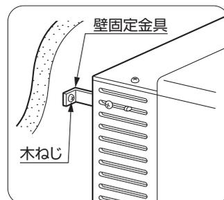
② モルタル、コンクリートの壁に固定する場合は、コンクリート用プラグを壁に打ち込んでから、①項と同様に壁固定金具で固定してください。
