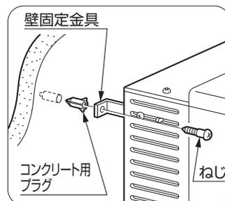
③ 石膏ボード、薄い合板など中空壁に固定する場合は、中空壁用プラグを壁に打ち込んでから、①項と同様に壁固定金具で固定してください。
