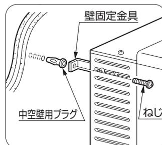
④ 土壁、しっくい壁などに固定する場合は、壁にそえ木をしてから、①項と同様に壁固定金具で固定してください。
