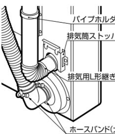
⑦断熱カバーを必ず排気筒の接続口までかぶせてください。
