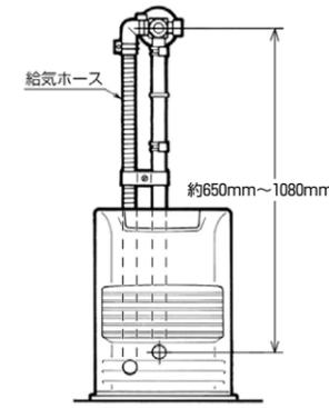
この1m用延長給排気筒セットを、利用することによって、給排気筒トップは、排気筒取付口より、約650~1080mmの間に取り付けることができます。
