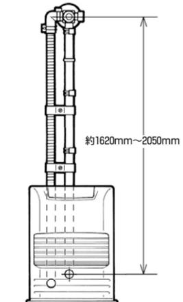
この2m用延長給排気筒セットを、利用することによって、給排気筒トップは、排気筒取付口より、約1620~2050mmの間に取り付けることができます。
