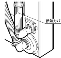
⑧伸縮排気筒を伸縮させながら給排気筒トップの排気側に取り付け、パイプホルダーで固定します。
