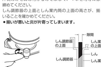
17 給油時消火装置のアームを指で押し下げながら、しんを上げてから「感震部」を押して、対震自動消火装置を起動させ、しんがスムーズに確実に下がるかどうか、2〜3回確認してください。
