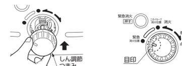
23 燃焼筒をしん調節器の上に正しくセットし、ガードを閉じて、油タンクを入れてください。乾電池を電池ケースに☉☺を正しく合わせて入れてください。
