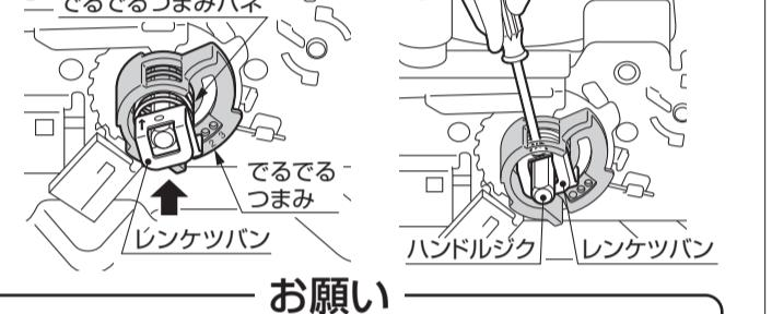
18 「感震部」を押して、対震自動消火装置を作動させ、しんがスムーズに確実に下がるかどうか、2~3回確認してください。
