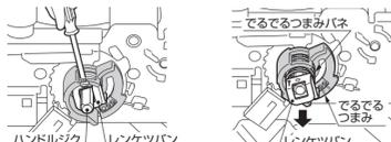
9 ハンドルジクを右方向「C」に必ず止まるまで回して、しん保持筒が最大まで上がった後にハンドルアームをしん保持筒の溝よりはずします。
