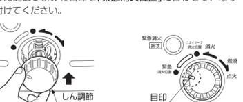
23 燃焼筒をしん調節器の上に正しくセットし、ガードを閉じて、油タンクを入れてください。乾電池を電池ケースに⊕⊖を正しく合わせて入れてください。
