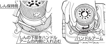
13 しん案内筒としん調節器の隙間が全周揃っている所で、1ページの6項ではずしたしん調節器の蝶ナット4本を、対角線上の各々2本ずつ均等に締めてください。片側のみを締め付けるのではなく、4本を均等に徐々に締めてください。しん調節器の上面としん案内筒の上面の高さが、揃っていることを確かめてください。
