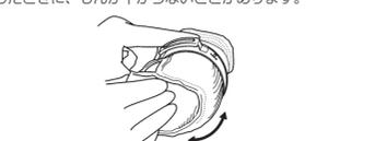
13 ハンドルジクを右方向「C」に止まるまで回してから、しん案内筒に、しん保持筒を取り付けたしんを差し込んで、しん案内筒になつかせてください。しん案内筒の溝に、ハンドルジクを左方向「C」に回しながらハンドルアームの先端を差し込み、ハンドルジクを止まるまで左方向「C」に回してしんを下げてください。
