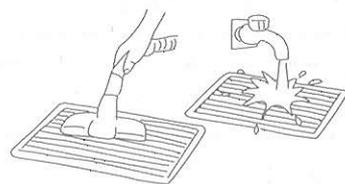
■掃除機でほこりを吸い取る。汚れがひどい場合は中性洗剤で洗ったあと、水洗いする。水洗いした場合は必ずよく陰干ししてから取付けてください。
