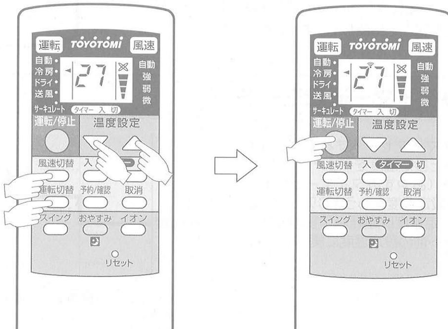
〔運転モード、風速設定、設定温度選択〕
