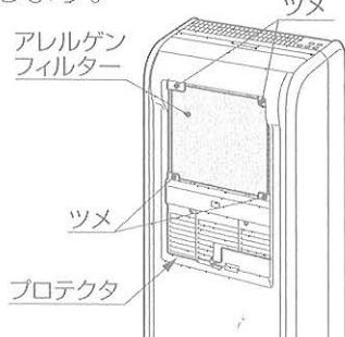
**3** プロテクタの右図の位置にプラスチックネジがありますので、⊕ドライバーを使ってネジを取りはずします。
