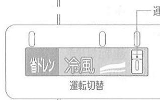
冷風で涼みたいとき、ドレン水(除湿水)の量を少なくさせたい場合に使用します。除湿量は低下しますが、電力量を低減できます。
