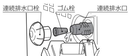
**3 連続排水口の先端にホースを取り付けます。**
