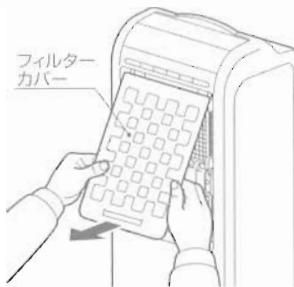
2 フィルターカバーを取りはずすと、プレフィルターがありますので、プレフィルターを取りはずします。
