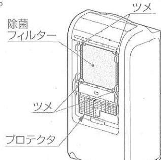
**3** プロテクタの右図の位置にプラスチックネジ(2本)がありますので、⊕ドライバーを使ってネジを取りはずします。
