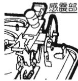
7 本体を元通りに組付け、燃烧筒をしん調節器の上に正しくのせてください。
