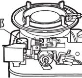
**7** 本体を元通りに組付け、燃焼筒をしん調節器の上に正しくのせてください。
