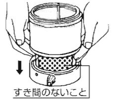
2 燃焼筒をしん調節器の上に正しくセットし、燃焼筒つまみを左右に2~3回動かして、燃焼筒が正しくセットされているか確かめてください。
