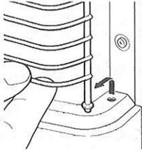
3 燃焼筒を納めている包装材を取り除き、燃焼筒を取り出してください。
