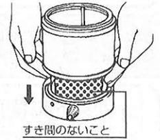
2 燃焼筒をしん調節器の上に正しくセットしてください。
