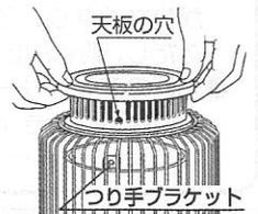
4 つり手を、正面側から、ガードの両側にあるつり手ブラケットの穴と、天板の両側にある穴を通して取り付けてください。
