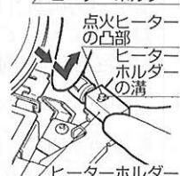
● 点火ヒーターのフィラメントに、指を触れて変形させないようにしてください。
