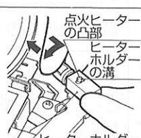
6 片手でヒーターholdderをつまみ、新しい点火ヒーターの凸部をヒーターholdderの溝を通すように入れたら、押しつけながら回して、点火ヒーターの凸部を、ヒーターholdderの凹部にはめ込んでください。
