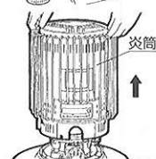
5 片手でヒーターholdderをつまみ、点火ヒーターを押しつけながら回して、ヒーターholdderから抜き取ってください。
