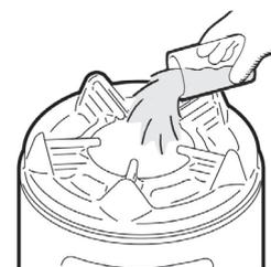
水をかけると水蒸気が出たりします。あわててヤケドをしないように、手袋をはめるか、手にタオルを巻くなどしてからおこなってください。また、後で油タンク内の水の入った灯油を抜き、しん交換が必要です。
