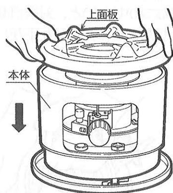
**20** 新しい灯油を給油後15分以上待って、しんに灯油が充分に吸い上げられてから、点火して、各部がスムーズに動き、正常に燃焼することを確認してください。
