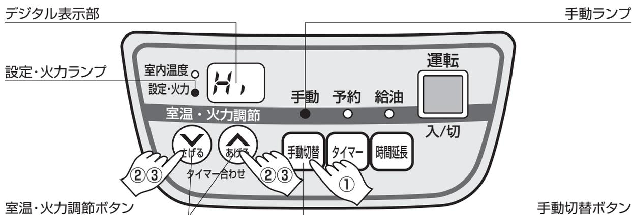
①「手動切替ボタン」を押して「手動ランプ」を点灯にする。
