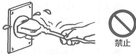
★電源プラグを抜くときは、電源コードを引っ張つて抜かないでください。断線、発熱、発火の原因になります。
