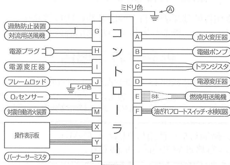
●配線図に記してあるⒶ印の脱着可能な配線は、誘導雷サージ防止部品の配慮であり、耐電圧試験のときだけとりはずして試験しないと正しく耐電圧試験ができません。
