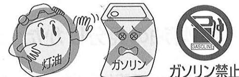
●変質灯油、不純灯油(灯油以外の油・水・ごみが混入した灯油など)は、絶対に使用しないでください。異常燃焼や故障の原因になります。
