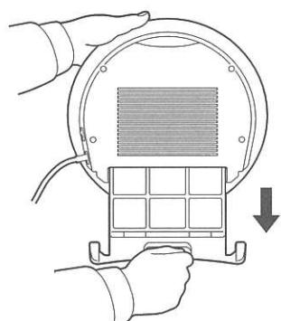
取り外しにくい時は、フィルターワークを下に下げるよう引くと、抜き取りやすくなります。
