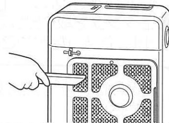
ときどき、燃焼・温風空気取入口(ファンフィルター)をはずして掃除をしてください。
