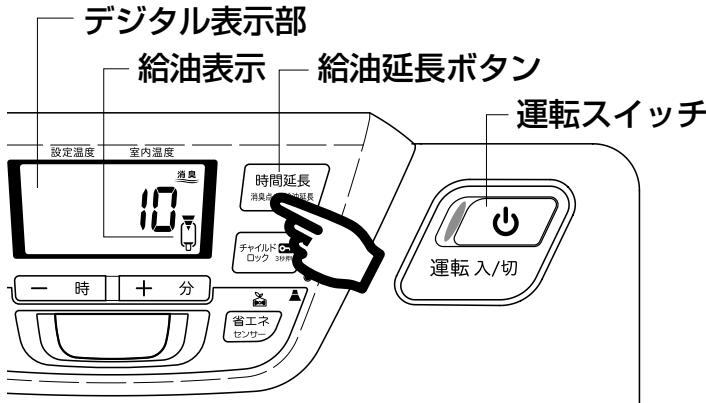
1 油タンクの灯油がなくなると、「」表示が点灯し、「ピー」音が鳴ります。デジタル表示部に残り燃焼時間（分）「」を表示します。
