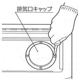
**3** 煙突取付口はストーブの外側に切り欠き部が向くように組み替えてください。
