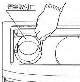
**2** 排気口キャップを固定している4本のねじをはずし、中のパッキンを損傷しないように排気口キャップをはずしてください。
