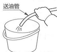
④バルブを全開にし、送油管から灯油に空気が混じらない状態で連続して流れ出ることを確認する。
