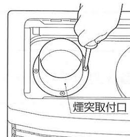
2 排気口キャップを固定している4本のねじをはずし、中のパッキンを損傷しないように排気口キャップをはずしてください。
