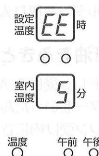
■燃焼中に安全装置で消火したときの表示 (エラー表示)
