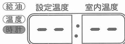
★このとき「給油ランプ」が「点滅」する場合は、ストーブに灯油がきていませんので、8ページの「燃料切れの注意」を参照して送油経路を点検してください。
