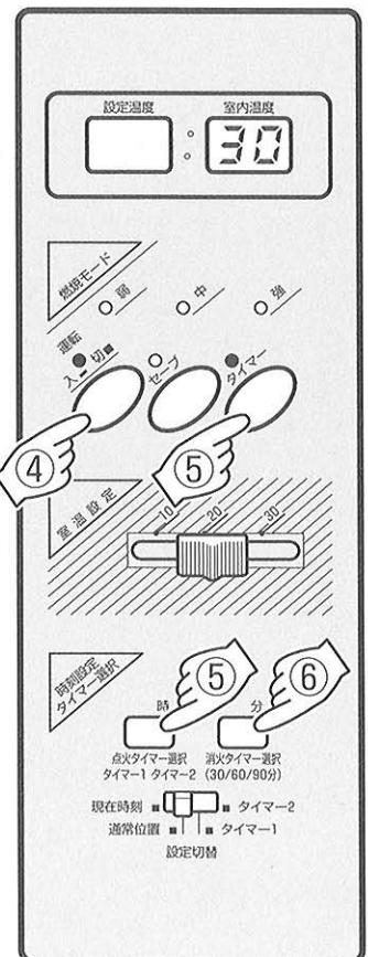
上記の操作により、消火タイマー設定時間終了後、運転を停止し、タイマー点火待機状態になります。
