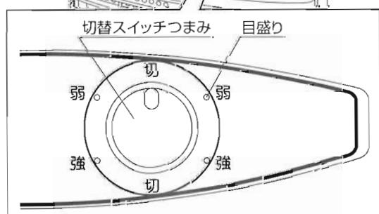
●切替スイッチつまみを目盛に合わせて通電してから約1分程度、ヒーターの膨張により「ビビビ」という通電音がしますが異常ではありません。しばらくすると音がしなくなります。
