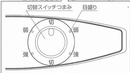
●切替スイッチつまみを目盛に合わせて通電してから約1分程度、ヒーターの膨張により「ビビビ」という通電音がしますが異常ではありません。しばらくすると音がしなくなります。
