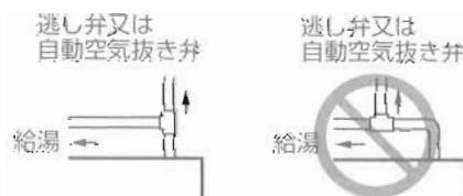
●逃し弁や自動空気抜き弁を取り付ける際は右図のような配管には注意してください。
