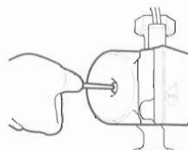
**10** 約10分後に給水バルブを閉じ、フロアアシスターの電源プラグをコンセントから抜きます。
