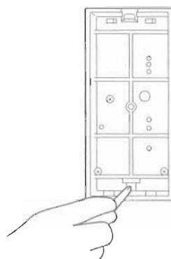
①リモコンカバーの止めねじ(1本)を外し、リモコンカバーとリモコンベースに分解してください。
