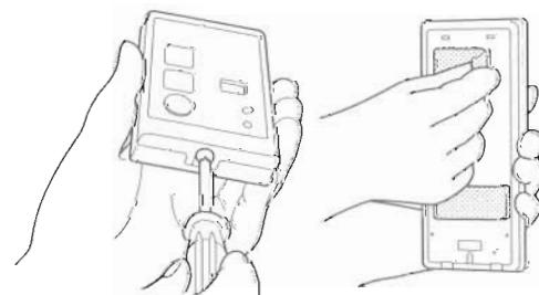
③リモコンコードのY端子をリモコン基板の接続部にねじで固定してから、図のようにリモコンコードをボスにからませるように取り回してください。
