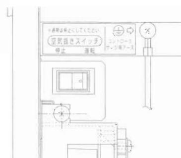
4 空気抜き終了後は、「空気抜きスイッチ」を必ず「停止」にしてください。
