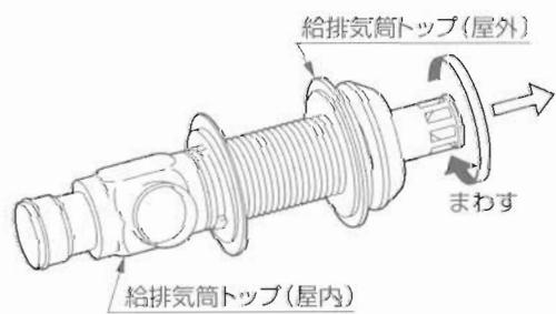
③給排気筒トップ(屋内)を壁穴に通し、トラスタッピンねじ(4本)で固定します。このとき、フランジ(屋内)の「ウ」の刻印が上側になるよう取り付けてください。
