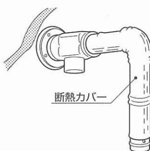
③伸縮管と伸縮エルボに附属品の断熱カバーをかぶせます。
