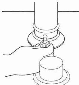
④ボイラの排気口のトラスタッピンねじをはずし、伸縮管の他方をボイラの排気口に差し込んでください。
