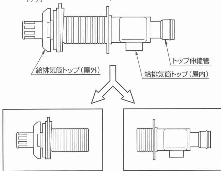
③給排気筒トップ(屋内)を壁穴に通し、トラスタッピングねじ(4本)で固定します。このとき、フランジ(屋内)の「ウ」の刻印が上側にくるように取り付けてください。
