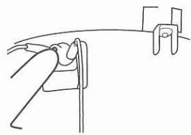
温度調節器の故障などで、熱交換器内の温度が異常温度まで上昇すると、バーナーが自動的に消火します。異常・故障の原因を取り除いてください。
