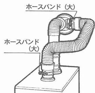
③もう一方のゴムジョイントにもホースバンド(大)を通し、ボイラの給気口にはめ込み、ホースバンド(大)で固定します。
