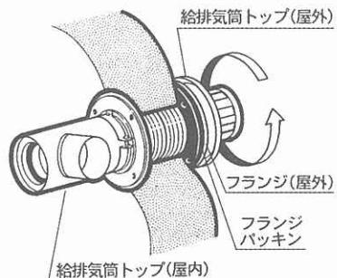
④屋外側から壁をはさんで給排気筒トップ(屋外)を給排気筒トップ(屋内)にねじ込んでください。このとき、フランジ(屋外)を「下」の刻印が下側にくるように押さえながら、給排気筒トップ(屋外)をねじ込んでください。
