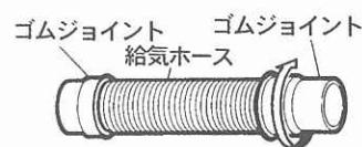
②一方のゴムジョイントにホースバンド(大)を通し、ゴムジョイントを給排気筒トップ(屋内)の給気口にはめ込み、ホースバンド(大)で固定します。
