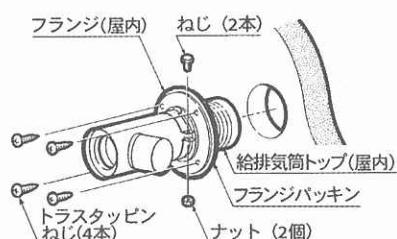
③給排気筒トップ(屋外)に付いているフランジ(屋外)の壁側にフランジパッキン(1枚)をはめ込み、フランジパッキンの壁側の全周にコーティング剤(シリコン系)を充分に塗布してください。
