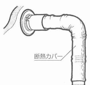
④ボイラの排気口のトラスタッピンねじをはずし、伸縮管の他方をボイラの排気口に差し込んでください。
