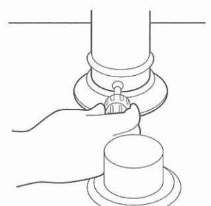
⑤ボイラと伸縮管、伸縮管と伸縮エルボの接続部及び排気筒の抜け止め用のねじ部をアルミテープで排ガスが漏れないように確実にシールしてください。足りない場合は、市販のアルミテープをお使いください。
