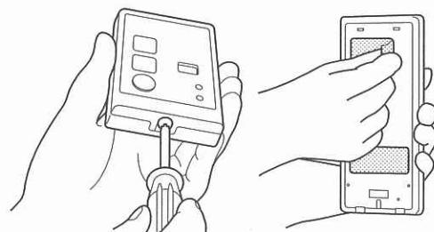
③リモコンコードのY端子をリモコン基板の接続部にねじで固定してから、図のようにリモコンコードをボスにからませるように取り回してください。
