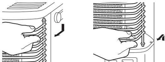
3 燃焼筒を納めている包装材を取り除き、燃焼筒を取り出してください。
