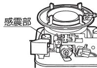
**7 本体を元通りに組付け、燃焼筒をしん調節器の上に正しくのせてください。**
