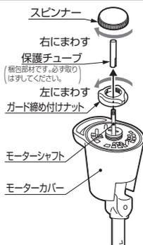
スピナー、保護チューブ、ガード締め付けナットをはずします。
