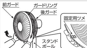
2. 組み立てかた(5・6ページ)と逆の順で羽根と後ガードを分解します。
