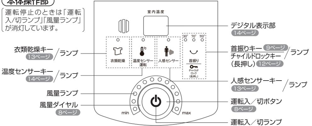
●「衣類乾燥キー」「温度センサーキー」「人感センサーキー」「首振りキー」は、タッチパネルキーです。タッチして操作してください。
