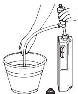
②わずかに残った灯油は、油タンクに給油口口金を取り付け、油受けを本体の中から取り出して給油口口金に押し当て、油タンクを上下にゆすって抜いてください。
