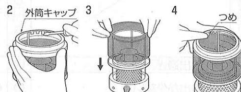
2 外筒キャップの内側のつめを、マイナスドライバーなどで起こし、外筒キャップを取りはずしてから、古い外筒(大)を取りはずします。
