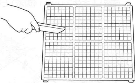
5 プレフィルターの汚れがひどい場合は、ぬるま湯か中性洗剤を溶かした水かぬるま湯で洗い、日陰で充分乾かしてください。
