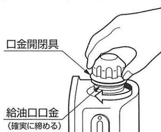
★給油口口金は、斜めに締めたり、締めつけが不完全ですと、油漏れによる火災の原因になります。また、違った給油口口金を取り付けますと油が出なくなります。
