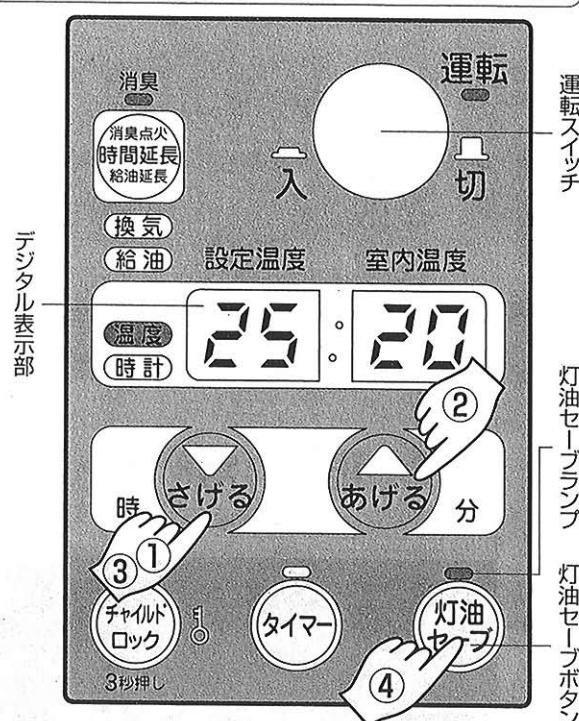
●温度設定をする場合は「温度」表示が「点滅」している間(約10秒間)に △・▽ ボタンのどちらかを押してください。
