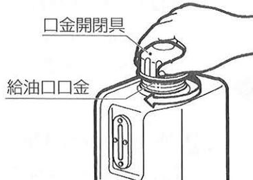
★給油口口金は、斜めに締めたり、締めつけが不完全ですと、油漏れによる火災の原因になります。また、違った給油口口金を取り付けますと油が出なくなります。
