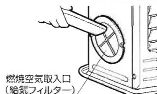
時々、燃烧空気取入口（給気フィルター）をはずして掃除をしてください。
