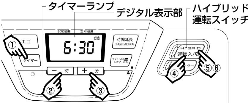
通常、タイマー運転設定時刻の0分から25分前に運転を開始します。このストーブのタイマー運転は、ファジークリントロールで、お部屋の大きさと室温により自動的に運転時刻を決定し、設定時刻には、お部屋を暖かくしておきます。
